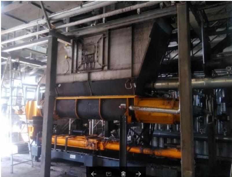
Abbildung 6: Beschickungspumpe
