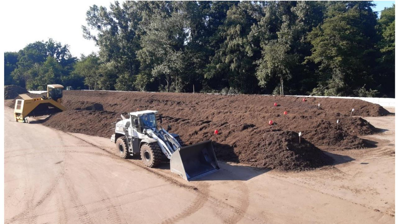
Abbildung 19: offene Mietenkompostierung mit Dreiecksmietenumsetzer und Radlader
