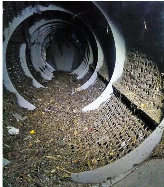
Abbildung 4: Siebtrommel
