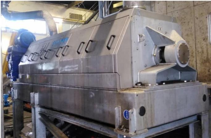
Abbildung 11: Schneckenpresse
