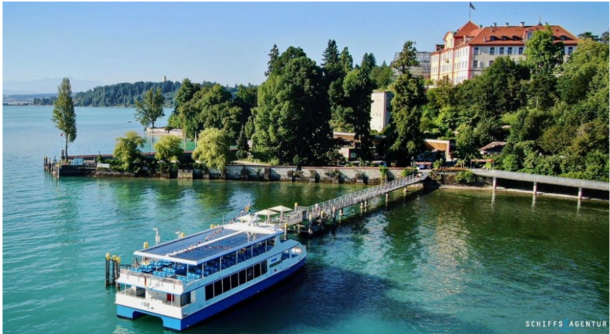
Abbildung 4.8: Solarschiff MS Mainau, mit 2 x 75kW Elektromotoren und bis zu 300 Passagieren (21)
