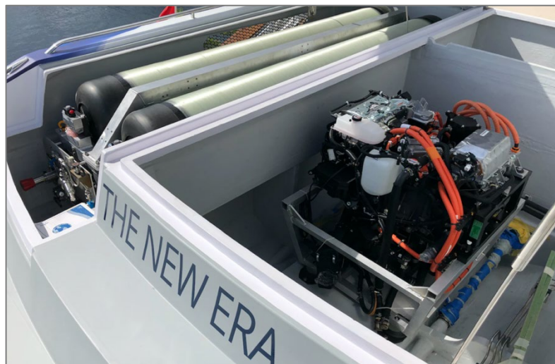
Abbildung 4.15: Wasserstoff-Yacht der Firma EODev mit der Brennstoffzelle aus dem Toyota Mirai (28)
