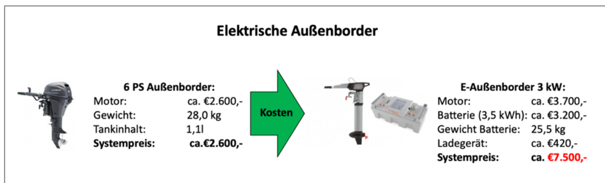
Abbildung 4.10: Vergleich von Kosten und Gewicht eines Außenbord-Antriebes mit Benzin-Motor und Elektroantrieb
