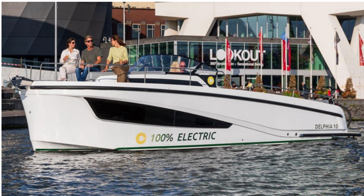
Abbildung 4.9: Sportboot mit 55 kW E-Antrieb von Delphia (22)
