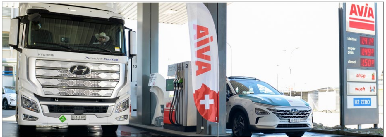
Abbildung 4.14: Avia Tankstelle in St. Gallen mit Brennstoffzellen-LKW und -PKW und Wasserstoff-Tanksäule (27)
